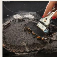
Jeśli zabrudzenie nie zejdzie po wykonaniu wyżej wymienionych czynności, należy użyć skrobaka z żyletką, przeznaczonego specjalnie do płyt szklano-ceramicznych.
