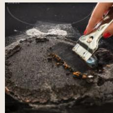
Als het op geen van de bovenvermelde manieren lukt om de resten weg te halen, gebruik dan een speciaal radeermes of speciale schraper voor kookplaten van keramisch glas.
