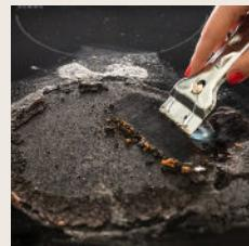
Если не получается удалить загрязнения ни одним из вышеописанных способов, используйте скребок с бритвенным лезвием, специально разработанный для очистки стеклокерамических варочных поверхностей.
